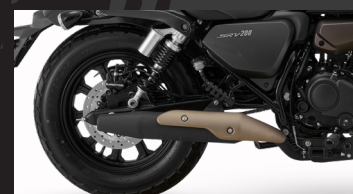
Amortiguación trasera de doble amortiguador de gas nitrógeno
