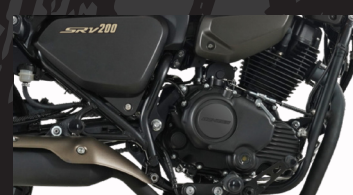
Motor monocilíndrico de 4 tiempos enfriada por aceite
